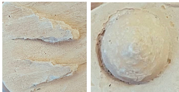
Рис. 6. Слепки, выполненные при помощи тиоколовой массы
